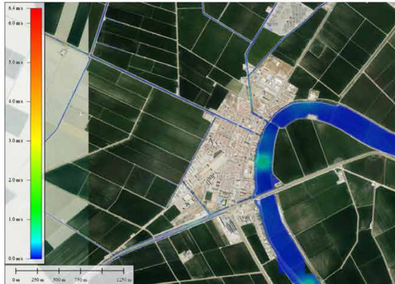
Imagen 42 – Mapa de velocidades máximas para el periodo de retorno de 50 años. Núcleo urbano de Isla Mayor.
