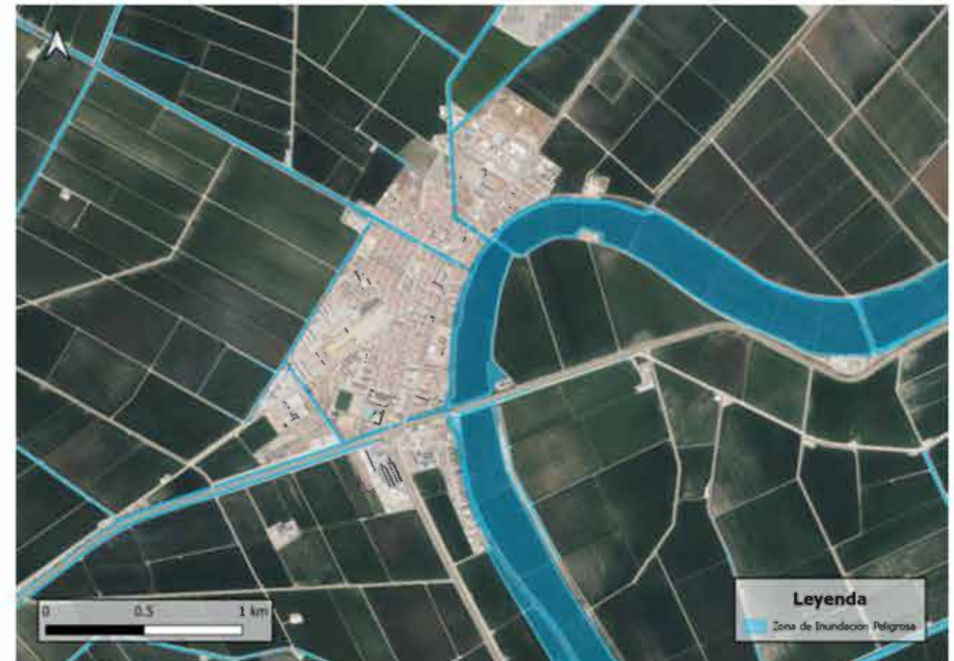
Imagen 58 – Delimitación de Zona de Inundación Peligrosa (ZIP). Núcleo urbano de Isla Mayor.
